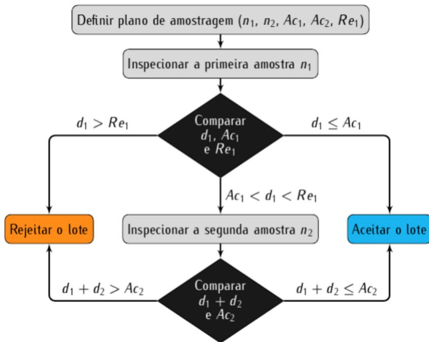
Figura 2. Plano de amostragem dupla (COSTA, EPPRECHT e CARPINETTI, 2010). Fluxograma adaptado pelos autores.
