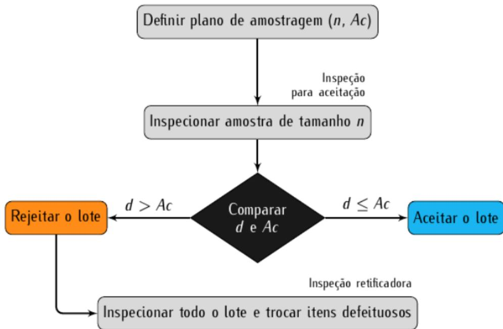
Figura 1. Plano de amostragem de aceitação com inspeção retificadora (COSTA, EPPRECHT e CARPINETTI, 2010). Fluxograma adaptado pelo autores.
